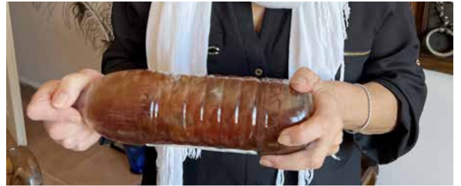
Resim 10: Toz gomalak ve ispiroto bulunan şişe yavaşça ve uzun süre sallanarak çözülmesi sağlanır. Cilanın hazır hale gelmesi için bir süre çalkalayıp güneş ışığında bıraktıktan sonra tekrar çalkalanması önerilir.
