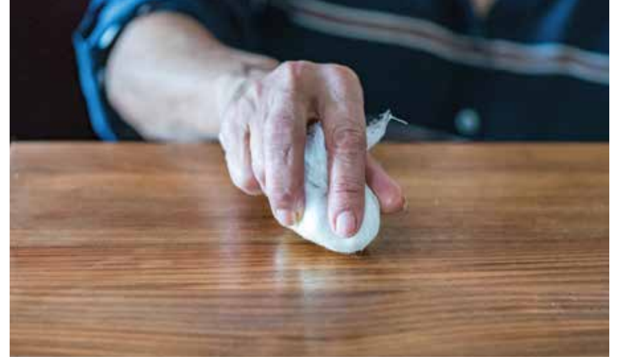
Resim 17: Ahşap yüzey, gomalak cilası ile özdeşleştikçe bütün desenleri ortaya çıkar
