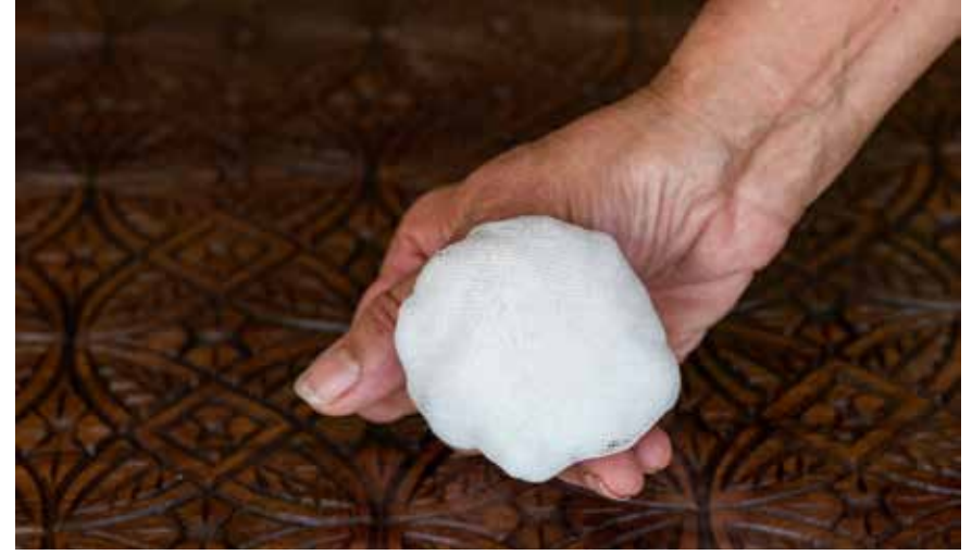
Resim 13: Pamuk gazlı bezin içerisinde kalacak şekilde gazlı bezin dört ucu bir araya getirilerek sıkıca tutulunca cila topu hazır hale gelmiş olur.
